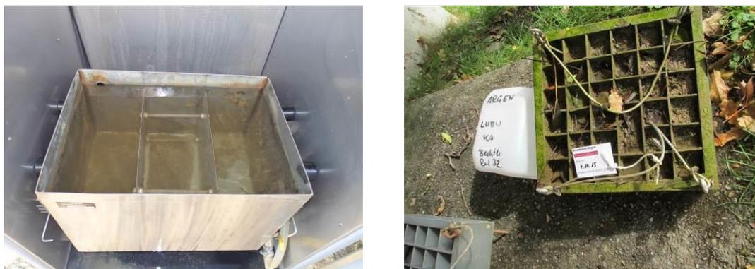
**Abb. 3: Probenahme von Schwebstoff mit einer Schwebstofffalle bzw. mit einem Schwebstoff-sammelkasten**
