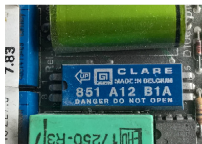
Abb. 2.7.9: Quecksilberhaltiges Bauteil auf einer Leiterplatte
