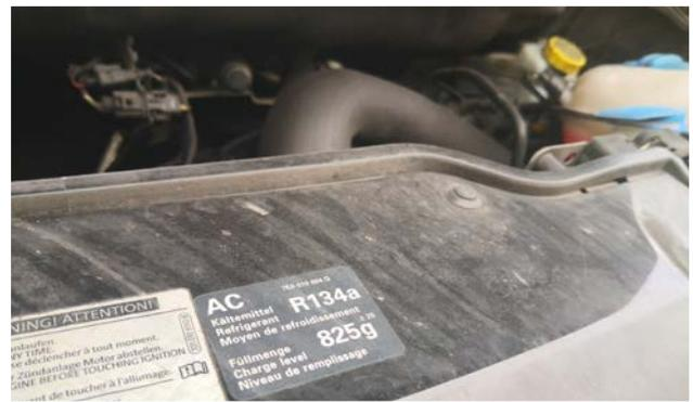
**Abbildung 3:** Verwendung von F-Gasen als Kältemittel in Kfz-Klimaanlagen. R134a als Wärmeträger bei einem VW Multivan (@ Kallis).
